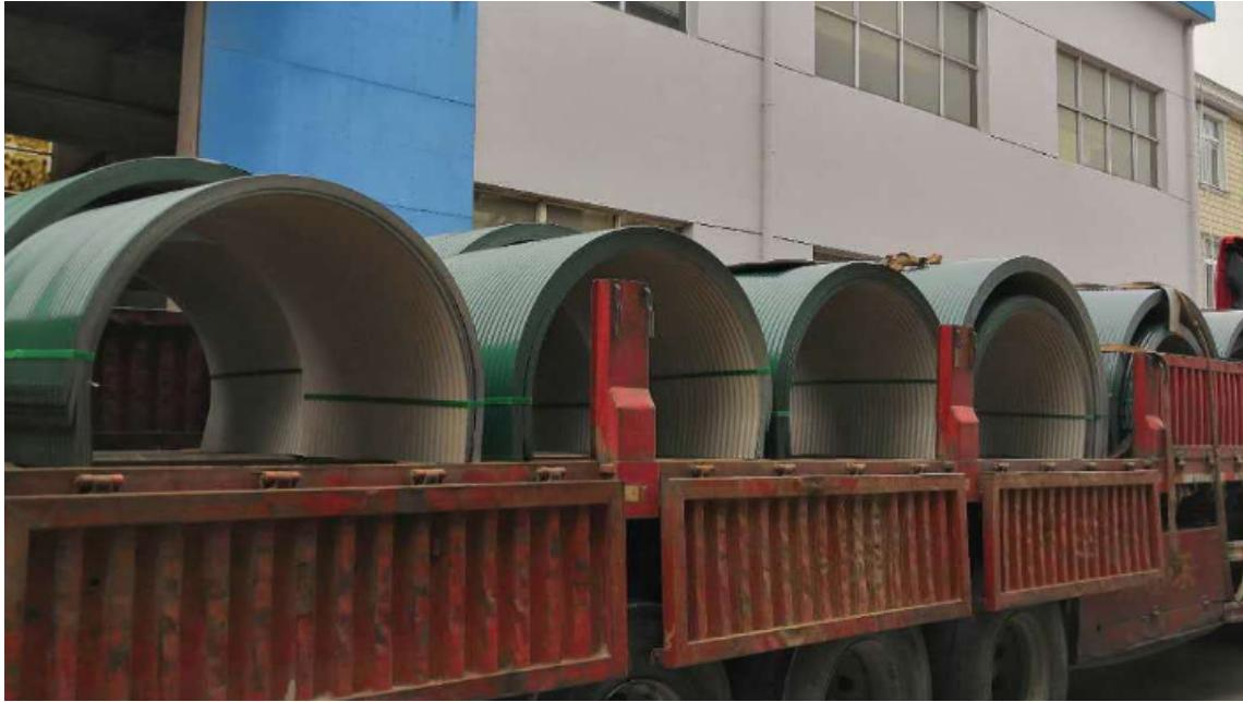
输送机防雨罩的用途及安装防雨罩定义：噪声户外长期监测时，为防雨并可进行远距离静电激励器校准，在传声器上装置的罩子。防雨罩的别称：防雨罩又称为防雨罩、彩钢防雨罩、输送机防雨罩、输送机防尘罩、皮带机防雨罩等。防雨罩对货物、环境起到极大作用，当货物在运输过程中可以减少货物的损失与浪费，使输送带在运输过程中更为安全可靠，其次也延长了运输机的使用寿命。防雨罩的应用行业：防雨罩广泛应用于电厂、水泥厂、钢铁厂、化工厂、煤炭厂、港口、码头、矿山企业等。防雨罩的作用：防雨罩对货物、环境起到极大作用，当货物在运输过程中可以减少货物的损失与浪费，使输送带在运输过程中更为安全可靠，其次也延长了运输机的使用寿命。防雨罩的样式：防雨罩有固定式、开启式和带观察窗口式，可以清楚的看到货物在传送过程中及传送带运行是否正常，更有跑偏罩，为设有跑偏开关的输送机起到防雨、防尘等作用。防雨罩的颜色主要种类为海蓝、白灰、红色等。防雨罩的主要程序：输送机防雨罩的生产需要多个工序完成，包括选板，上料，压型，剪板，压弧，调高，包装等。防雨罩安装及注意事项作为固定输送机罩的骨架为连接角钢或Z型钢，其长度与输送机罩安装长度相等。
