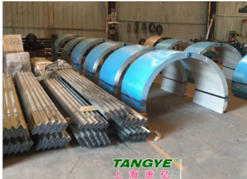
皮带机防雨防尘罩和镀锌钢板防雨罩大是正弦小波，波的高是10mm波的距离是32mm各种材质的防雨罩又有固定罩、开启罩和跑偏开关罩等类型，并且还可以按照用户的实际需求进行设计。所有配件出厂前都已经作防锈处理了。皮带机防雨防尘罩的安装程序皮带机防雨防尘罩作为产品运输的一种机械来说，需要进行严格的保护，无论是在那些行业，输送机都需要做好环境保护的工作，不能因为环境因素而影响作业，皮带机防雨防尘罩是用来保护输送机运输过程中，防止产品受到环境影响的一种产品。皮带机防雨防尘罩的安装步骤：1、安装按照顺序将防雨罩以品的形状进行搭接，从输送机一头向另外一头进行有序安装。2、安装时需要搭接一个波。3、安装时严谨站在防雨罩上，使用过程中应避免猛烈冲撞敲打等情况。4、防雨罩定位后，采用螺栓或特制夹具将罩子法兰边与输送机支撑板连接，每个罩子至少要有4个以上连接固定点。5、防雨罩在运输和贮存中要堆放平整以免产品变形和损坏。皮带机防雨防尘罩的安装步骤，需要严格按照顺序来进行安装，以免因操作失误引起不必要的麻烦。
